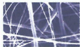
troisième couche de filtration intérieure
